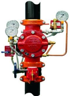
دیلوچ ولو (Deluge Valve) تجهیزاتی هستند که درقطع و مصل جریان آب در سیستم های سیلابی همچون اسپری نازل ها و فوم اسپرینکلرها و سیستم های مشابه استفاده می‌گردد. این تجهیزات قابلیت فرمان بذیری به صورت الکتریکی، مکانیکی و دستی را دارند. این تجهیزات سریعاً پس از دریافت فرمان جریان آب را به سوی نازل های خروجی هدایت می‌کنند و می‌توانند پس از انجام عملیات دوباره به حالت اولیه جریان آب را قطع نمایند.
